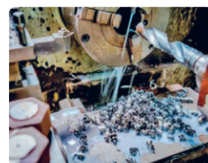
Figura 6.18 – A usinagem de peças metálicas é feita com o auxílio de um líquido refrigerante, que evita o aumento da temperatura causado pelo atrito da ferramenta com a peça.
